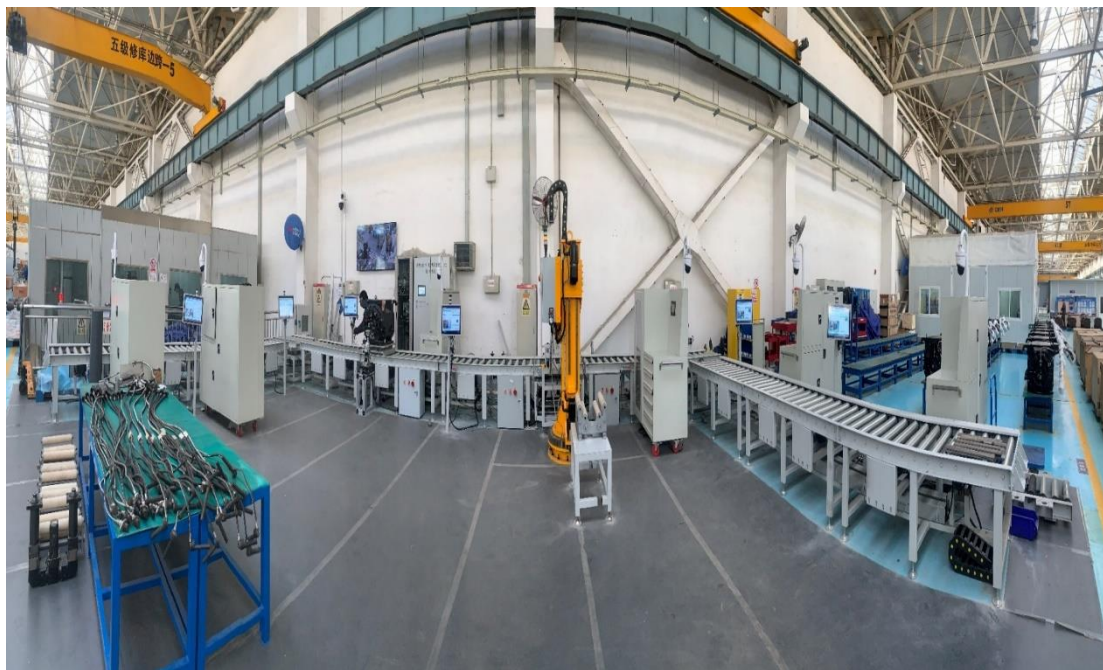
动车组牵引电机检修流水线
